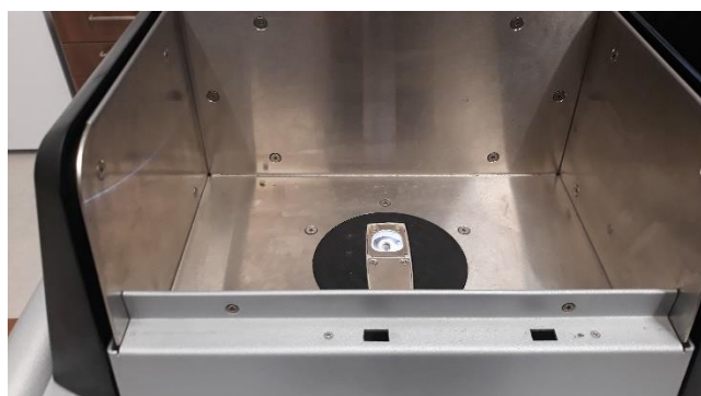
Figuras III-3 y 4. En el centro de la máquina se observa una luz donde se debe colocar el recipiente con la muestra para su procesamiento. (Fotografías Dora García).
