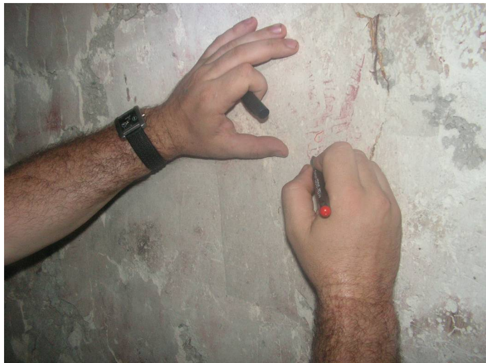
Figura III-91: El metodo del calco en el papel transparente (fotografía por T. Drápela).
